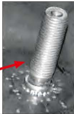
Штифты для крепления палубных направляющих
