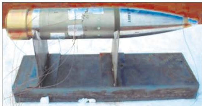
Лабораторный стенд с датчиками на снаряде М982 для проведения испытания нагреванием
